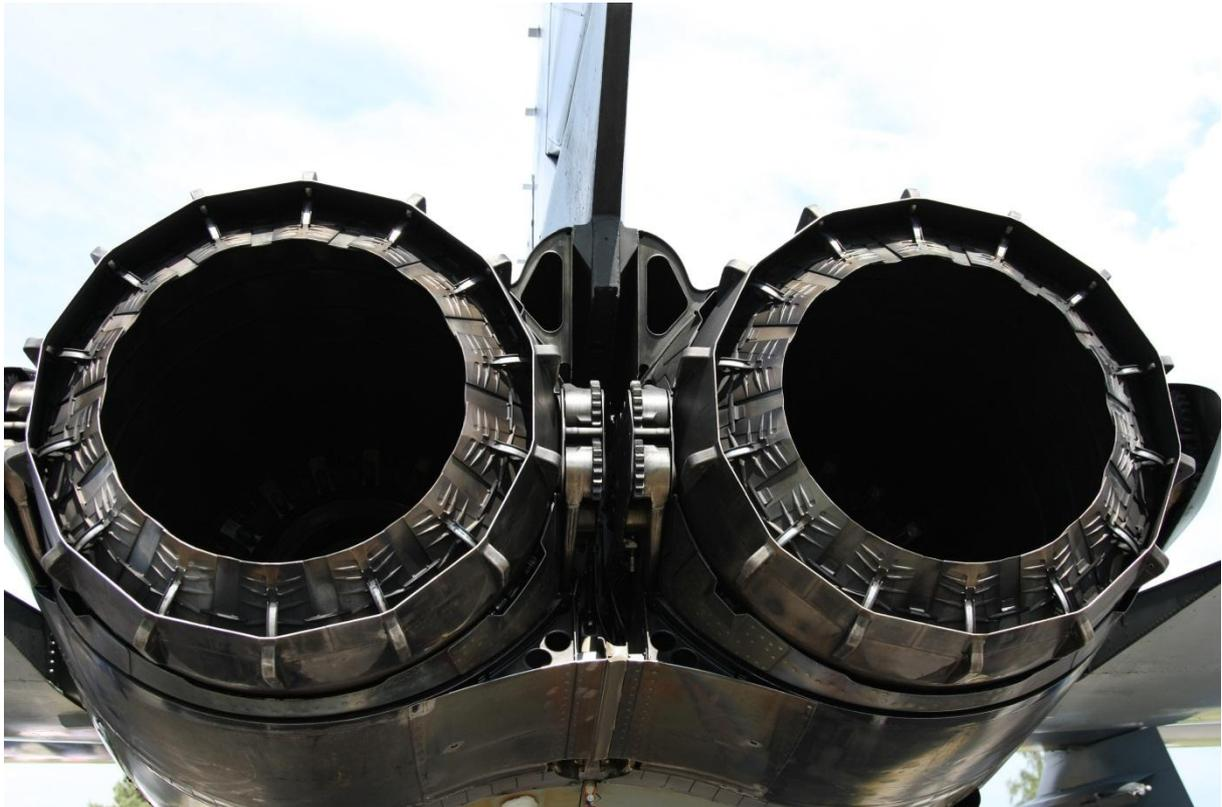
Das Ende. Die Nozzeln am Hinterteil der Tornado sind geschlossen... Sie regeln den gewaltigen Schub des Flugzeugs
